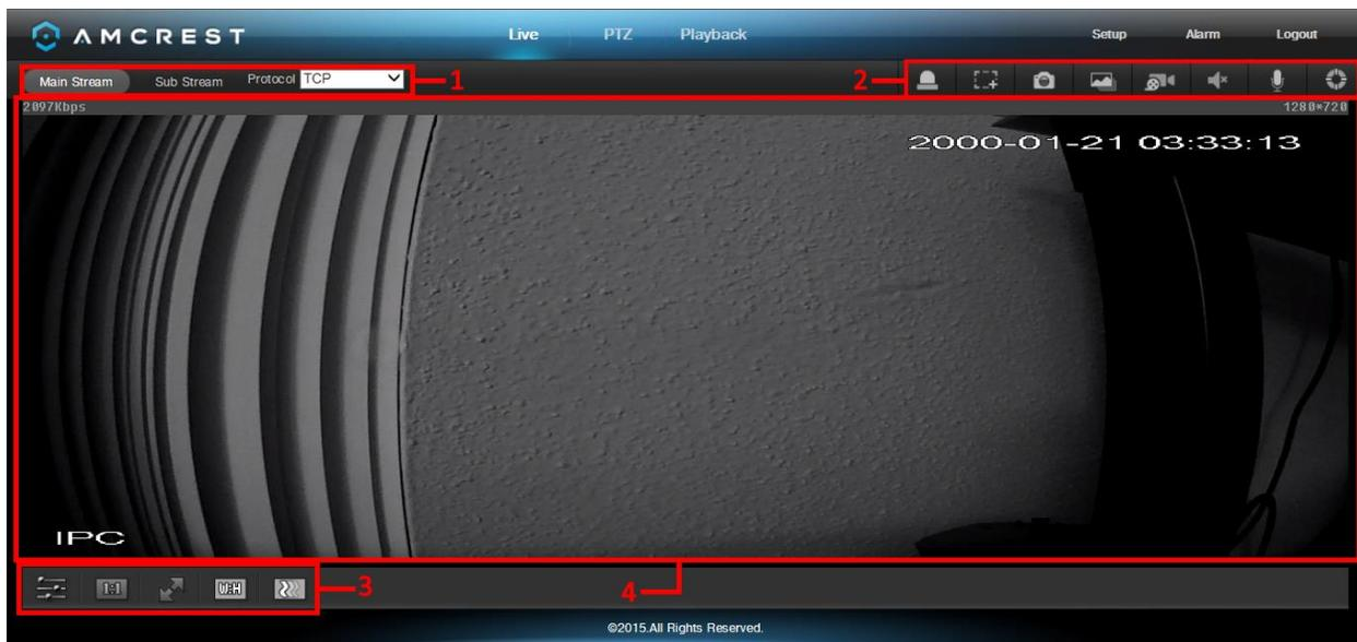
**Abschnitt 1:** Diese Leiste ermöglicht dem Benutzer, den Stream-Typ und Protokoll auswählen. Für weitere Informationen über Streamtypen finden Sie im Abschnitt 5.4.1.2.1. Weitere Informationen zu Protokollen finden Sie im Abschnitt 5.4.2.2.1.
