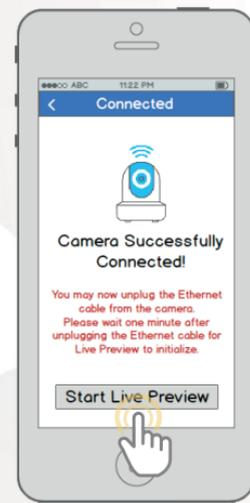
¡Su cámara ya está lista! Desconecte la cámara de Ethernet y enciéndala, luego traslade la cámara a algún lugar dentro del rango de la red WiFi a la que conectó la cámara. Conecte la cámara, luego espere 1-2 minutos antes de pulsar el botón "Start Live Preview".
